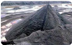
Sinter Feed 0,15 – 6,35 mm
